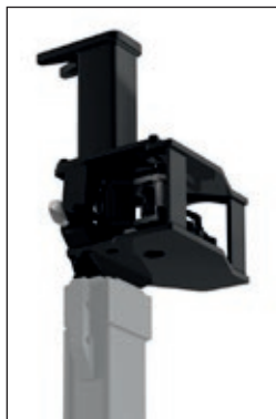
Svetruck 594 2 horizontale Haken und zusätzliche seitliche Klammern zur Aufnahme von 2 Containern
